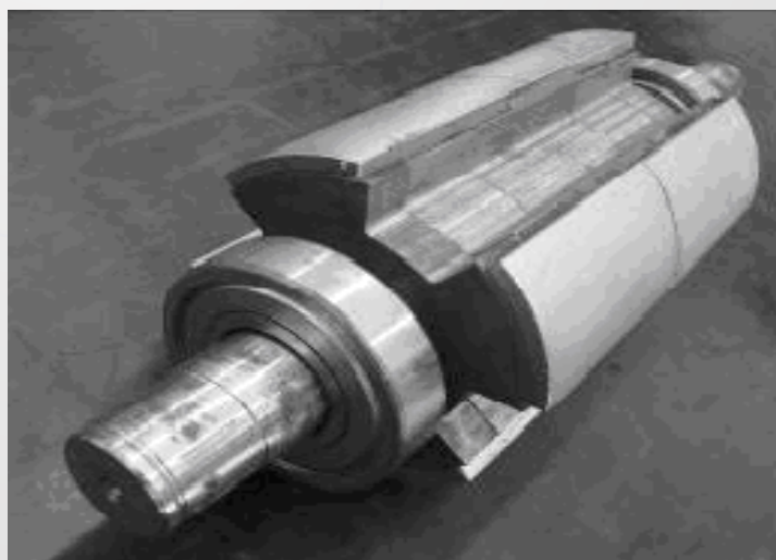
5b - Rotor desenvolvido com os ímãs fixados
